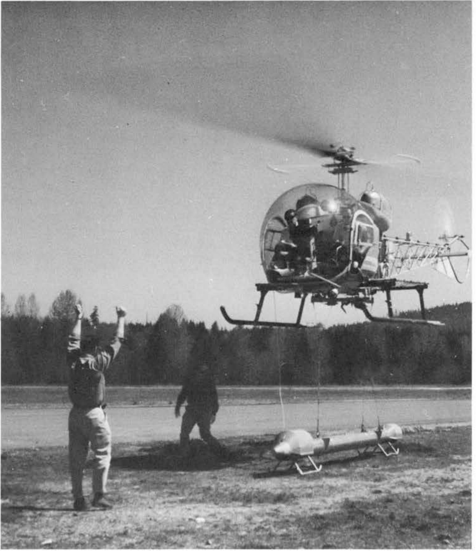
Hélicoptère muni de caméras 70 mm jumelées, montées sur longeron suspendu, pour photographies en couleurs et infrarouge d'herbes marines intertidales transportant des oeufs de hareng.
