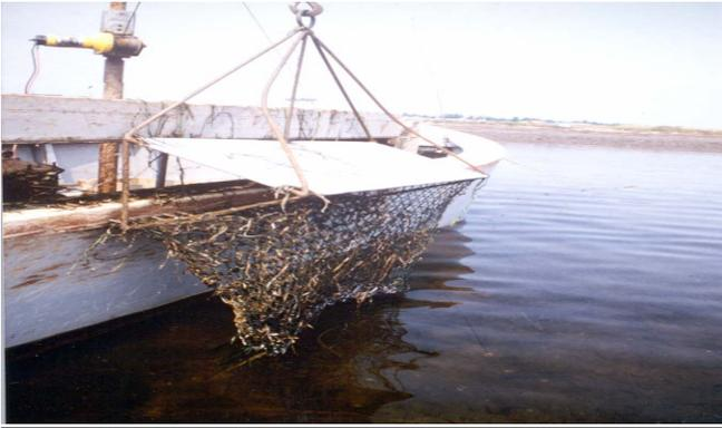
La drague ne peut être utilisée que pour pêcher les huîtres à de grandes profondeurs. Elle ressemble à un grand râteau qui aurait été doublé d'un sac et dont le manche aurait été remplacé par un câble puissant (figure 4). Elle est remorquée sur le fond par un bateau à moteur et est levée par un dispositif mécanique ou à moteur.
