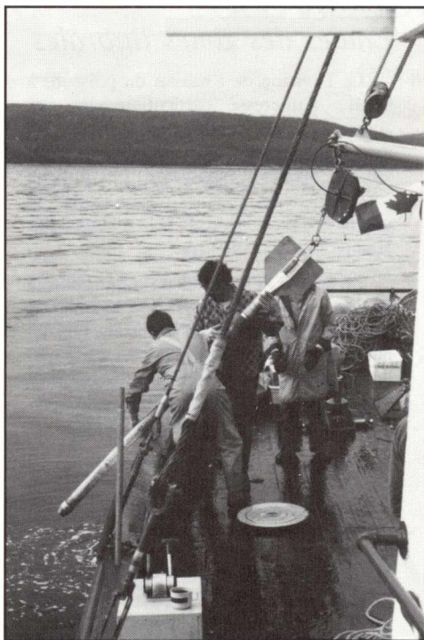
Le prélèvement de sédiments marins à l'aide de carotier permet d'accumuler des données pertinentes sur la contamination des habitats du poisson et d'en identifier les secteurs problématiques.
