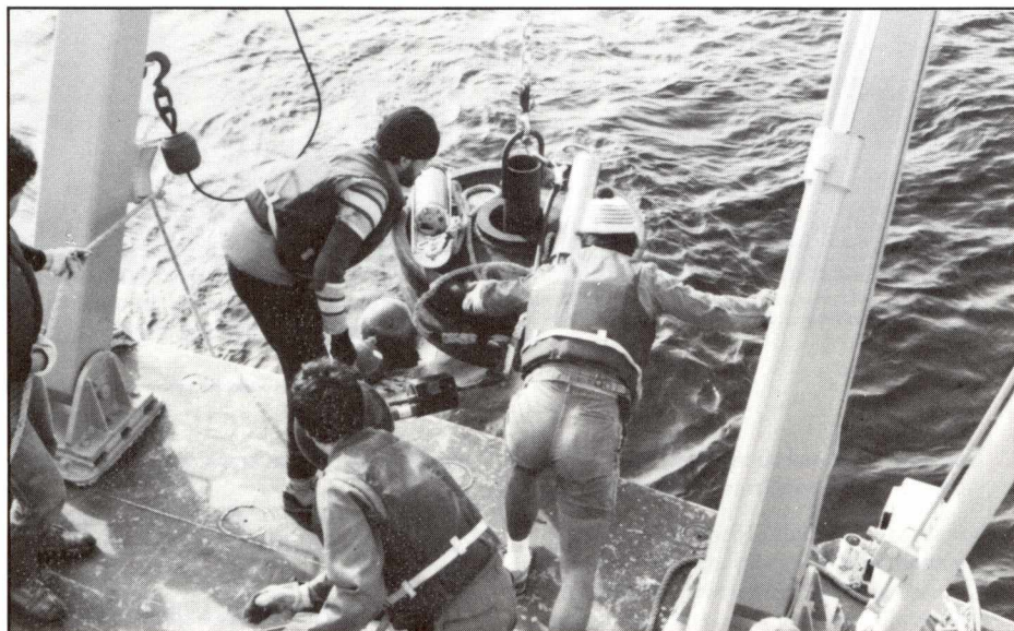
Mise à l'eau de l'ancre qui retient la ligne d'appareils de mesure. Un marégraphe a été installé du côté gauche.
