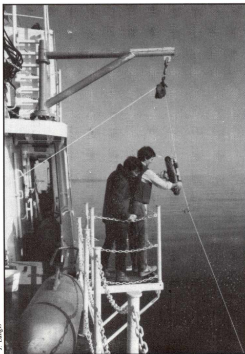
Échantillonnage d'eau à l'aide d'une bouteille «Niskin»
