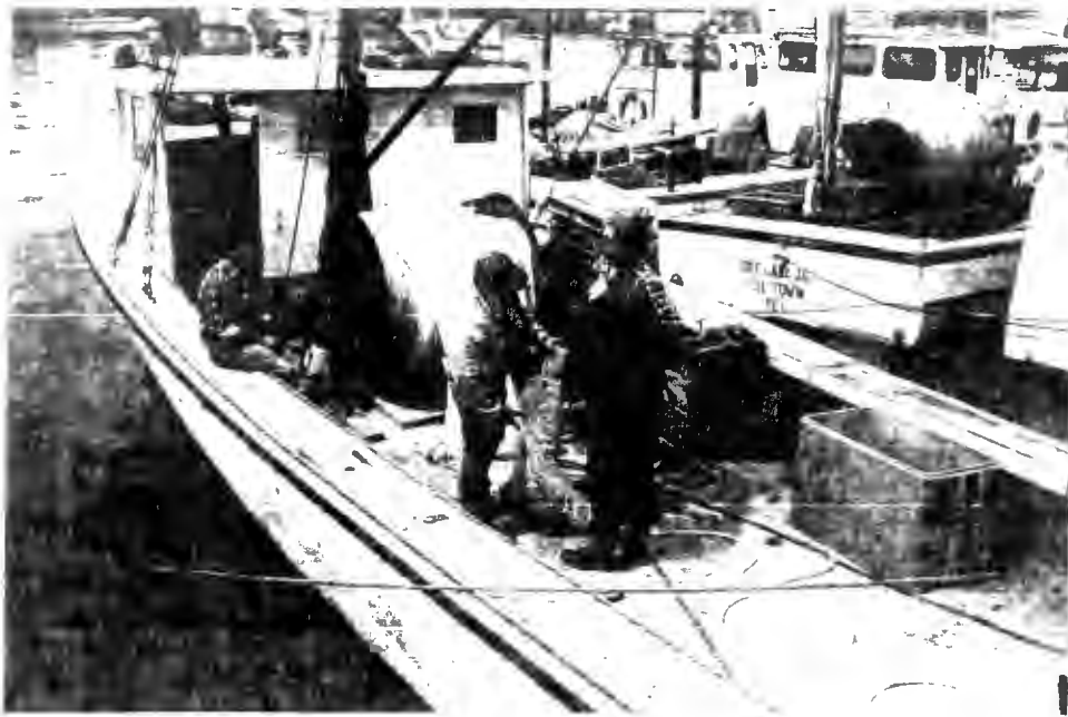
Photo 9 : Fermeture du cul-de-chalut. Le "Charlene Helene" est muni d'un mât et d'une flèche de grue en acier, mais remarquer le filin et le câble léger de l'appareil de levage.
