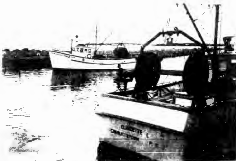
Photo 26 : Le "Claudette L" et son bateau jumeau, le "Melissa Anne II", ont été conçus et construits exclusivement pour la pêche à la senne à deux bateaux. Remarquer les dévidoirs, les poulies mécaniques et les mâts et flèches en acier.
