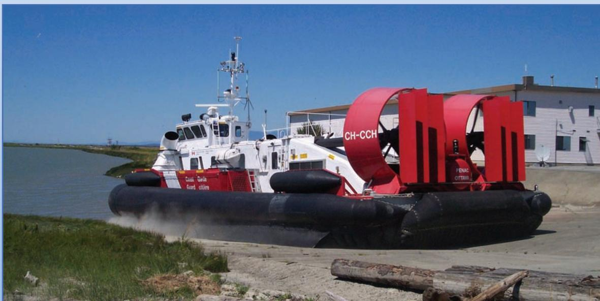
Mise à l'eau d'un véhicule sur coussin d'air de la GCC
