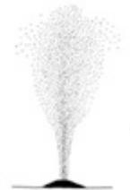
Haute expulsion d'air en forme de colonne pouvant atteindre 6 m
