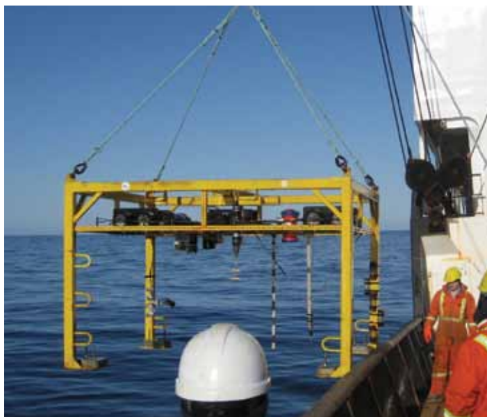
Figure 1. Le module de descente d'instruments sur le fond marin, RALPH, de la CGC Atlantique, est remonté du chenal du Flétan à partir du NGCC Ann Harvey .
