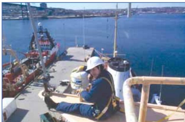
Mylène DiPenta, Technologue en entretien électronique remplaçant une antenne satellitaire au haut du grand mât sur le NGCC Hudson , navire hauturier de recherche halieutique et océanographique
