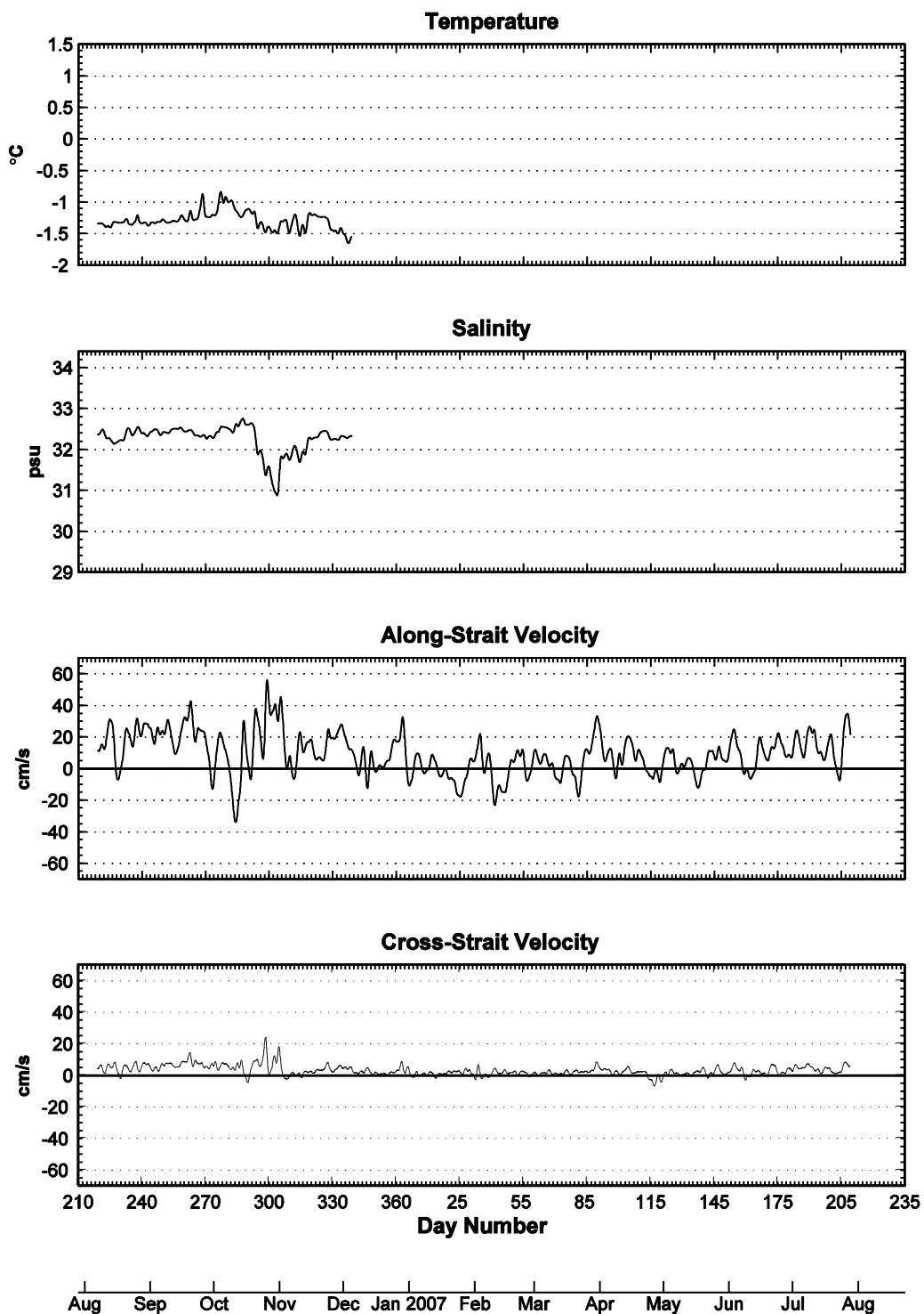
**Figure 20: Low-pass filtered T,S (87 m.) and current data (79 m.).**
