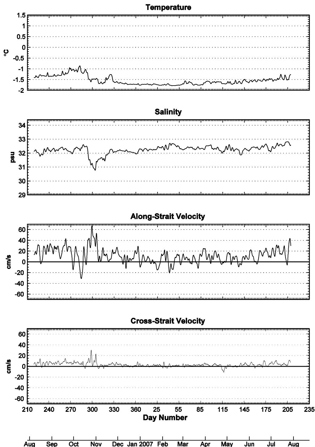
**Figure 19: Low-pass filtered T,S (62 m.) and current data (63 m.).**
