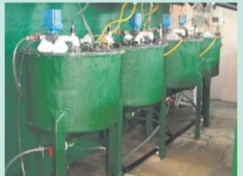
Système de respiromètres automatisé, régulé par ordinateur, utilisé pour mesurer le coût de la digestion chez des groupes de morues franches et d'aiglefins juvéniles.
