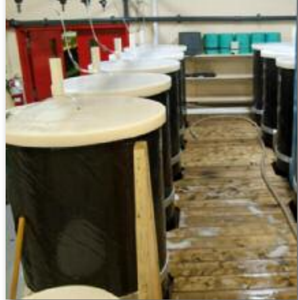
450-L cylindrical-conical tanks used for greenwater culture of American Lobster larvae Jean Côté (Regroupement des Pêcheurs Professionnels du Sud de la Gaspésie)
